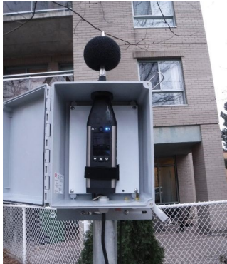
Installation d'un sonomètre.
